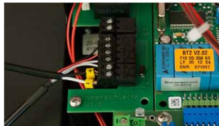
Schließen Sie die Stromversorgung an der Platine an.
