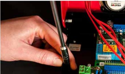
Drehen sie nun die Stehbolzen auf die montierten Schrauben und schrauben die Platine fest.
