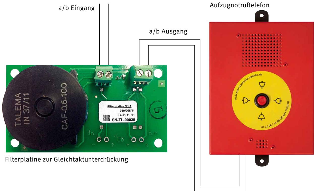
Filterplatine zur Gleichtaktunterdrückung
