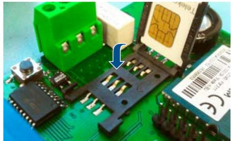
Legen Sie die SIM-Karte so ein, dass die Metallkontakte nach unten zeigen und die abgeschnittene Ecke nach oben zeigt.
