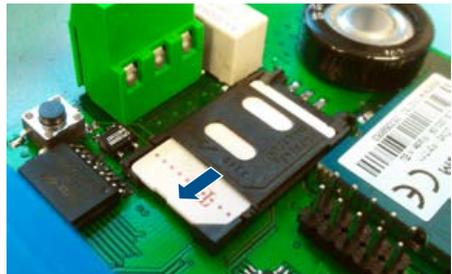
Schließen Sie den SIM-Kartenhalter-Verschluss, so dass er die SIM-Karte flach festhält. Schieben Sie den SIM-Kartenhalter von den Scharnieren weg, um ihn einrasten zu lassen.
